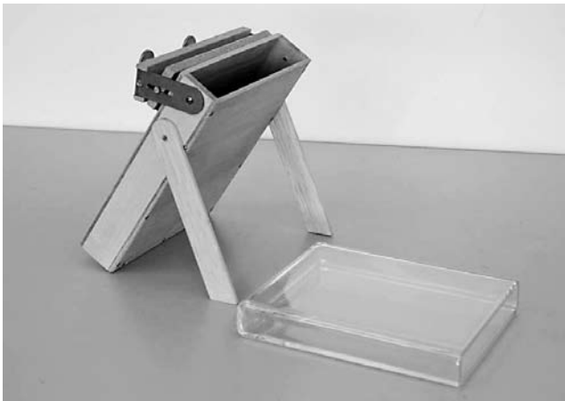
fig.6 キャビネ判銀浴器（復元品） 原型・富重写真所蔵
